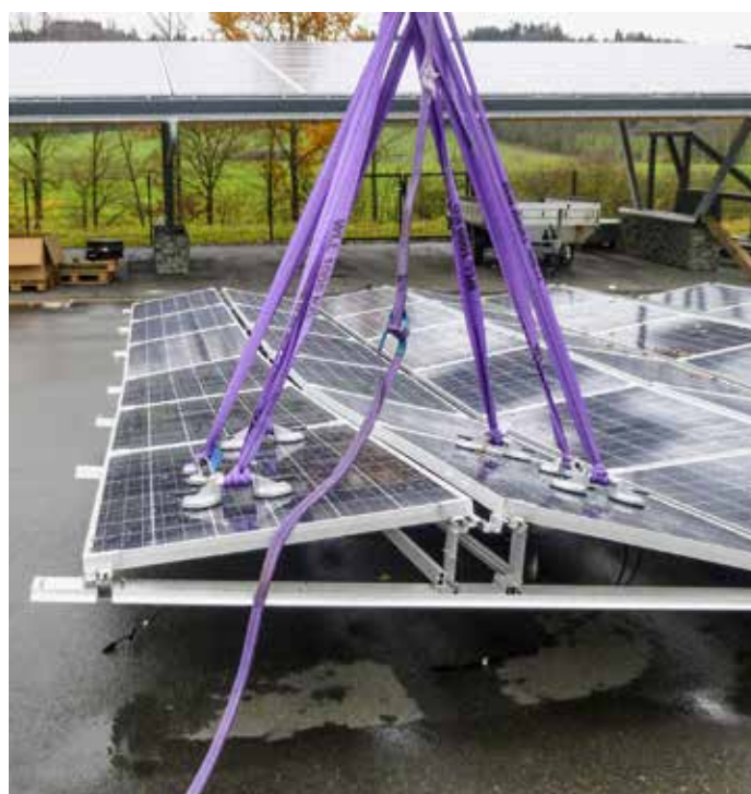
Hier sieht man sehr gut, dass die Ecke des Modulfeldes besonders anfällig für abhebbende Kräfte ist.
