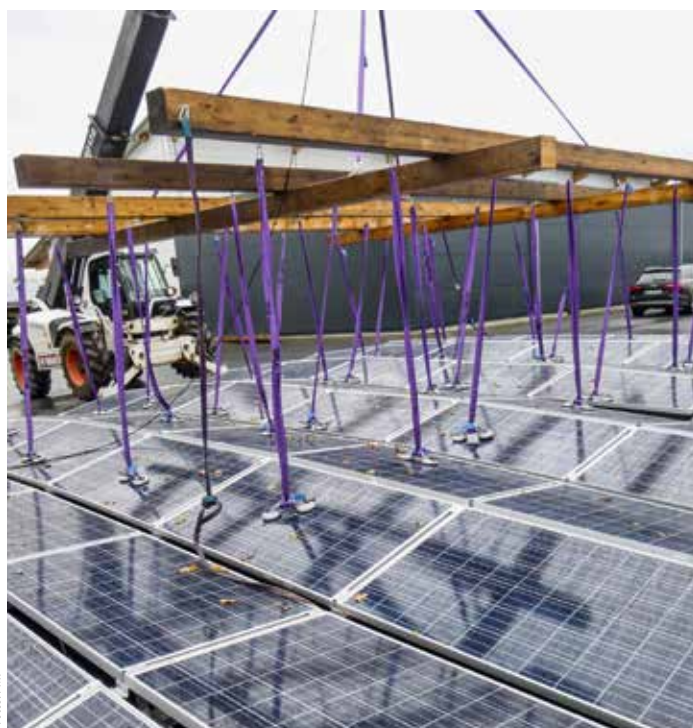
Versuche gegen Abheben: Neben dem Druck spielen aerodynamische Kräfte eine wesentliche Rolle, die den Solargenerator vom Dach saugen.
